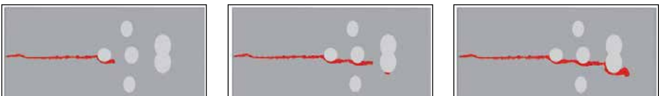
Abbildung 2: Simulation der Wechselwirkung eines Risses (rot) mit Nanoeinschlüssen (helle Ovale) auf der Basis eines mehrskaligen Werkstoffmodells
